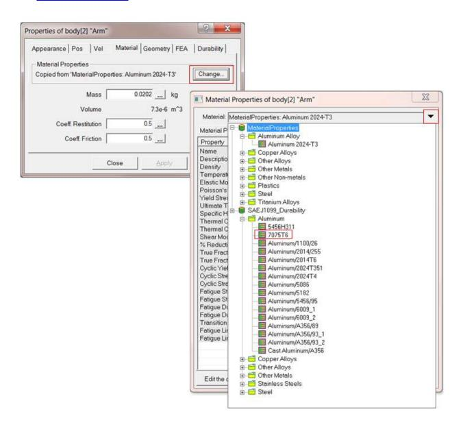
Scegliere di includere la parte nell'analisi a fatica e specificare l'utilizzo delle proprietà del materiale assegnate al corpo (l'opzione Other Material consentendo di provare altri materiali diversi da quelli assegnati in partenza al modello solido CAD).
